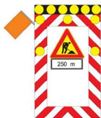
Figura 14: "segnale mobile di preavviso" derivato dalla fig. II 400 Art.39 Reg. da impiegare per lavori sulla sola corsia di emergenza. E' integrato con set di 6 lampade a led ad alta efficienza luminosa diam. 300 mm (con possibilità di lampeggio sincrono e sequenziale) e con sbandieratore elettromeccanico posto in alto sul lato esposto al traffico.
