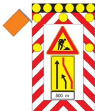
Figura 12: "segnale mobile di preavviso" fig. II 400 Art.39 Reg. da impiegare su tratti autostradali con corsia di emergenza per la chiusura di una o più corsie di transito (la figura esemplifica la chiusura della corsia di marcia in dx). E' integrato con set di 6 lampade a led ad alta efficienza luminosa diam. 300 mm (con possibilità di lampeggio sincrono e sequenziale) e con sbandieratore elettromeccanico posto in alto sul lato esposto al traffico.
