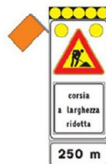
Figura 14: "segnale mobile di preavviso" derivato dalla fig. II 400 Art.39 Reg. da impiegare per lavori sulla sola corsia di emergenza. E' integrato con set di 6 lampade a led ad alta efficienza luminosa diam. 300 mm (con possibilità di lampeggio sincrono e sequenziale) e con sbandieratore elettromeccanico posto in alto sul lato esposto al traffico.
