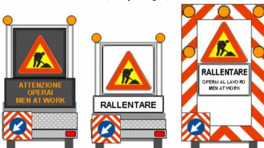
Figura 1: esempi di preavviso (carrelli con PMV o di tipo semplice o segnali mobili) da utilizzare in presenza di operai al lavoro sulla carreggiata nelle fasi di installazione della segnaletica. Il pannello 90x90 Fig. II 398 Art.38 Reg., va obbligatoriamente applicato contestualmente al posizionamento del carrello.
