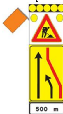
Figura 12: "segnale mobile di preavviso" fig. II 400 Art.39 Reg. da impiegare su tratti autostradali con corsia di emergenza per la chiusura di una o più corsie di transito (la figura esemplifica la chiusura della corsia di marcia in dx). E' integrato con set di 6 lampade a led ad alta efficienza luminosa diam. 300 mm (con possibilità di lampeggio sincrono e sequenziale) e con sbandieratore elettromeccanico posto in alto sul lato esposto al traffico.
